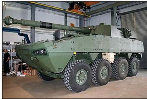
Верзија за ватрену подршку са топом СТ-CV-105 mm
